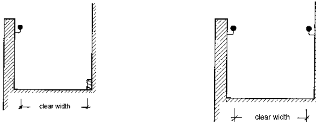
Obrázok B13: Priechodná šírka schodišťového ramena
